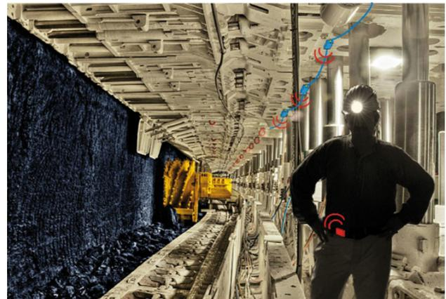
Die Auswertung von Empfangssignalstärken mittels Distanzapproximationen stellt hierfür eine einfache und mehrfach erprobte Möglichkeit der funkbasierten Ortung in geschlossenen Räumen dar. Als problematisch erweisen sich dabei Signalinterferenzen durch Mehrwegeausbreitung, welche in Form von „Small Scale Fading“ in wenigen Fällen zum Signalausfall, in jedem Fall aber zu einer Signalverformung führen.
