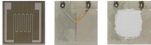
Dünnschicht-Heizer und Temperatursensor zur thermischen Untersuchung von aktiven Lot- und Schutzschichten
