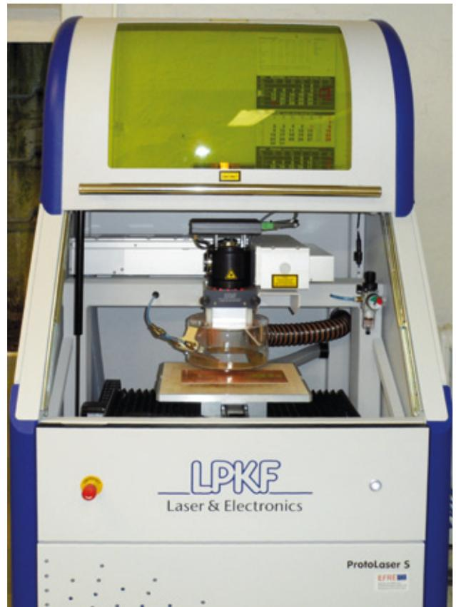
Abb. 3: Laserbearbeitung von Leiterplatten
