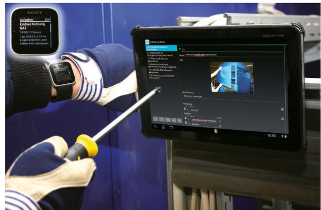
*Montageassistenz mit Smartwatch und Tablet*
